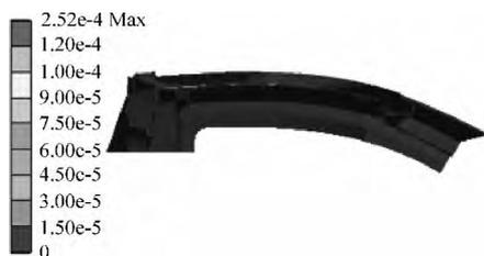
图6 改进前全塑车身顶盖总变形量分布图
